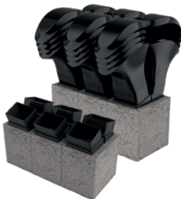
Sposób montażu adapterów na pustaku 120x170. Uwaga - elementy wypustu adaptera należy skierować na zewnątrz pustaka względem osi.
