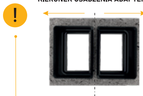
Sposób montażu adapterów na pustaku 100x160. Uwaga - elementy wypustu adaptera należy skierować na zewnątrz pustaka względem osi.
